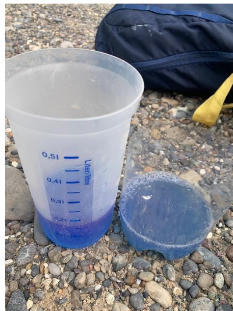
4. Das gefärbte Wasser vor und nach der Durchsickerung. Man sieht, dass das gefilterte Wasser heller ist. Der Boden hat also das Wasser ein bisschen gesäubert.
